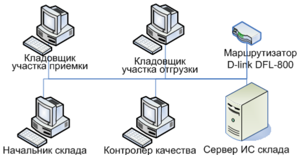
Рисунок 1. Техническое обеспечение ИС склада
